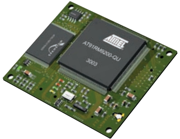
Так выглядит RISC-процессор ARM9 от ATMEЛ, часто используемый в качестве программного декодера в DVD-проигрывателях
